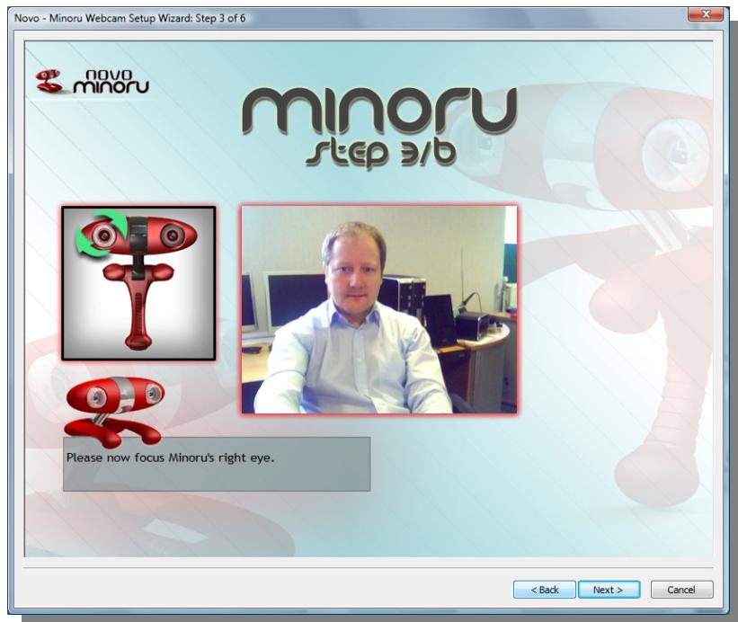
Mettere a fuoco l'occhio destro di Minoru ruotando il cerchio della lente fino ad ottenere un'immagine nitida del viso dell'utente.
